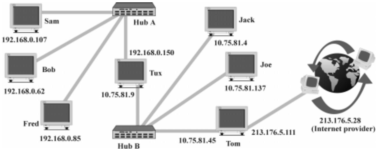
Le poste **Tux**, au centre de notre schéma, fait partie à la fois du réseau **A** et du réseau **B**. C'est cette machine qui constitue la *passerelle* entre les deux réseaux, en effectuant le travail que l'on appelle *routage des paquets IP*. Elle possède deux cartes réseaux, l'une avec une adresse valide dans le réseau **A** (192.168.0.150) et l'autre avec une adresse valide dans le réseau **B** (10.75.81.9).
